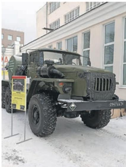
на специальной обработке техники, предназначена для дезактивации, дегазации и дезинфекции наружных поверхностей техники мощными газовыми и газочапельными потоками. Она может быть использована также для дегазации и дезактивации участков местности дорог с твёрдым покрытием.
